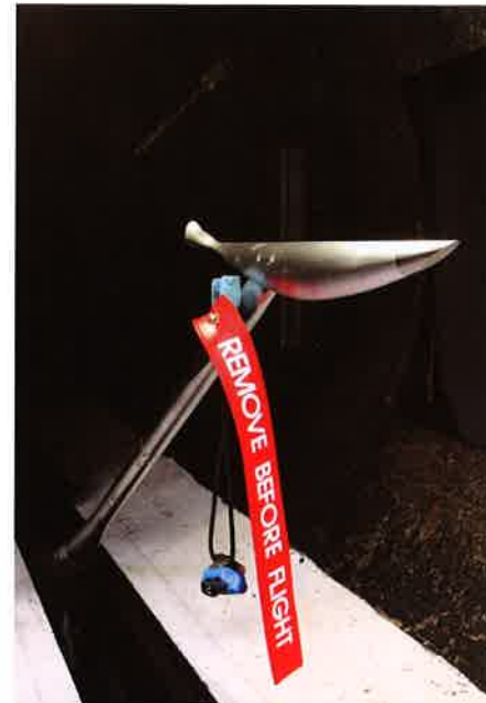
Die Replik im Windkanal ist mit 69 cm Länge nur halb so groß ...
