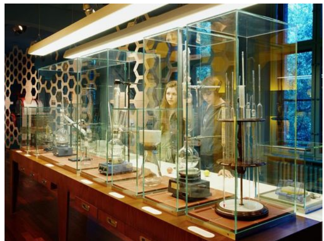
Wie wird im Chemielabor gearbeitet? Die im Deutschen Technikmuseum ausgestellten Instrumente verdeutlichen verschiedene Verfahren wie die Destillation, Filtration oder Extraktion chemischer Stoffe. Foto: SDTB / Musiol
